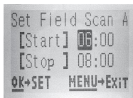
(Шаг 3) -установите время начала и окончания Field Scan блока «А»
